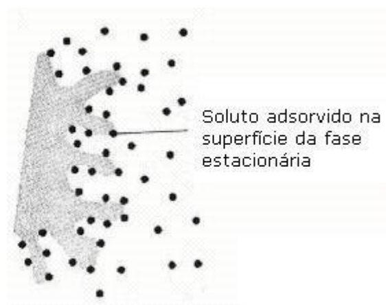
Figura 7 - Representação do processo de adsorção
