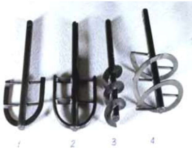
Figura 2.11 – Impelidores utilizados por BATTAGLINI (1998): 1 – âncora convencional; 2 - âncora modificada; 3 - parafuso 4 - fita helicoidal.
