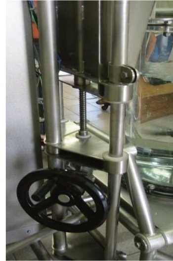
Figura 3.9 – (a) Vista lateral da porção responsável pela alteração de altura do impelidor e (b) foto real.
