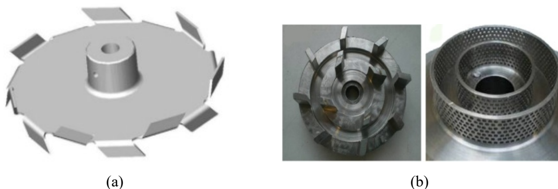
Figura 2.7 – Impelidores de Alto Cisalhamento: (a) High Speed Disperser Blade e (b) Impelidor Rotor-Estator.
