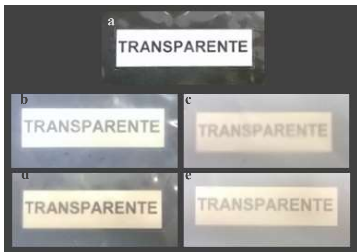
Figura 5.2: Aspecto visual dos filmes controle e nanocompósitos reticulados em primeiro e segundo estágio: Controle (a), 3% US RS (b), 20% US RS (c), 3% T RS (d) e 20% T RS (e).
