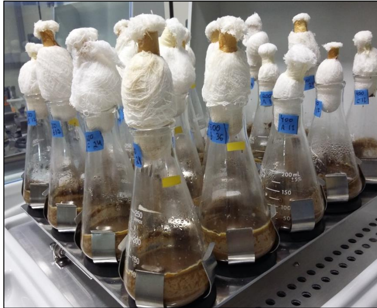
Figura A. 3 - FSm por A. niger em escala de bancada com FT liquefeito.
