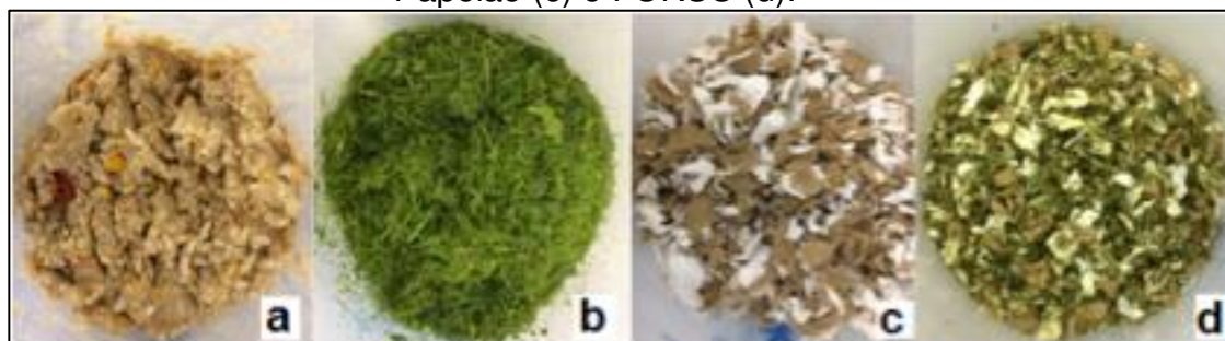
Figura 28 - Amostras simuladas das frações: Alimentar (a), Jardim (b), Papel e Papelão (c) e FORSU (d).
