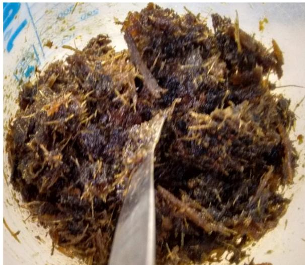
Além disso, é possível observar a lignina insolúvel que foi removida para o licor após o pré-tratamento. Para isso, foi necessária a adição de um co-solvente (água) e conseqüentemente sua regeneração no licor de pré-tratamento (Figura 4.12).
