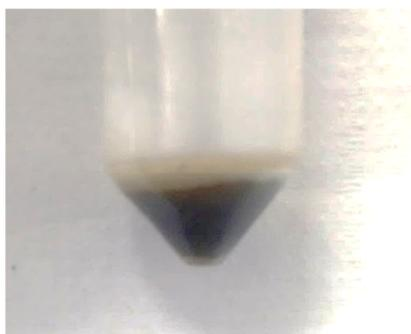
A lignina é solubilizada durante o pré-tratamento de acordo com o aumento da severidade. Ao final do processo e com a adição de água (antisolvente) a lignina que possui massa molecular média alta precipita.
