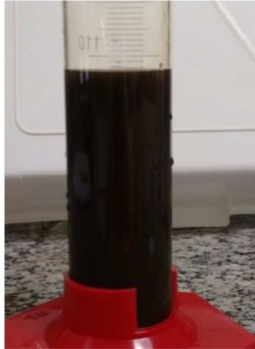
**Figura 3.5** - Bagaço lavado após o pré-tratamento com 2HEAA.
