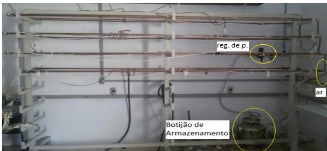
Figura 3.1 Sistema utilizado para simulações de vazamentos (LCAP/FEQ/Unicamp)
