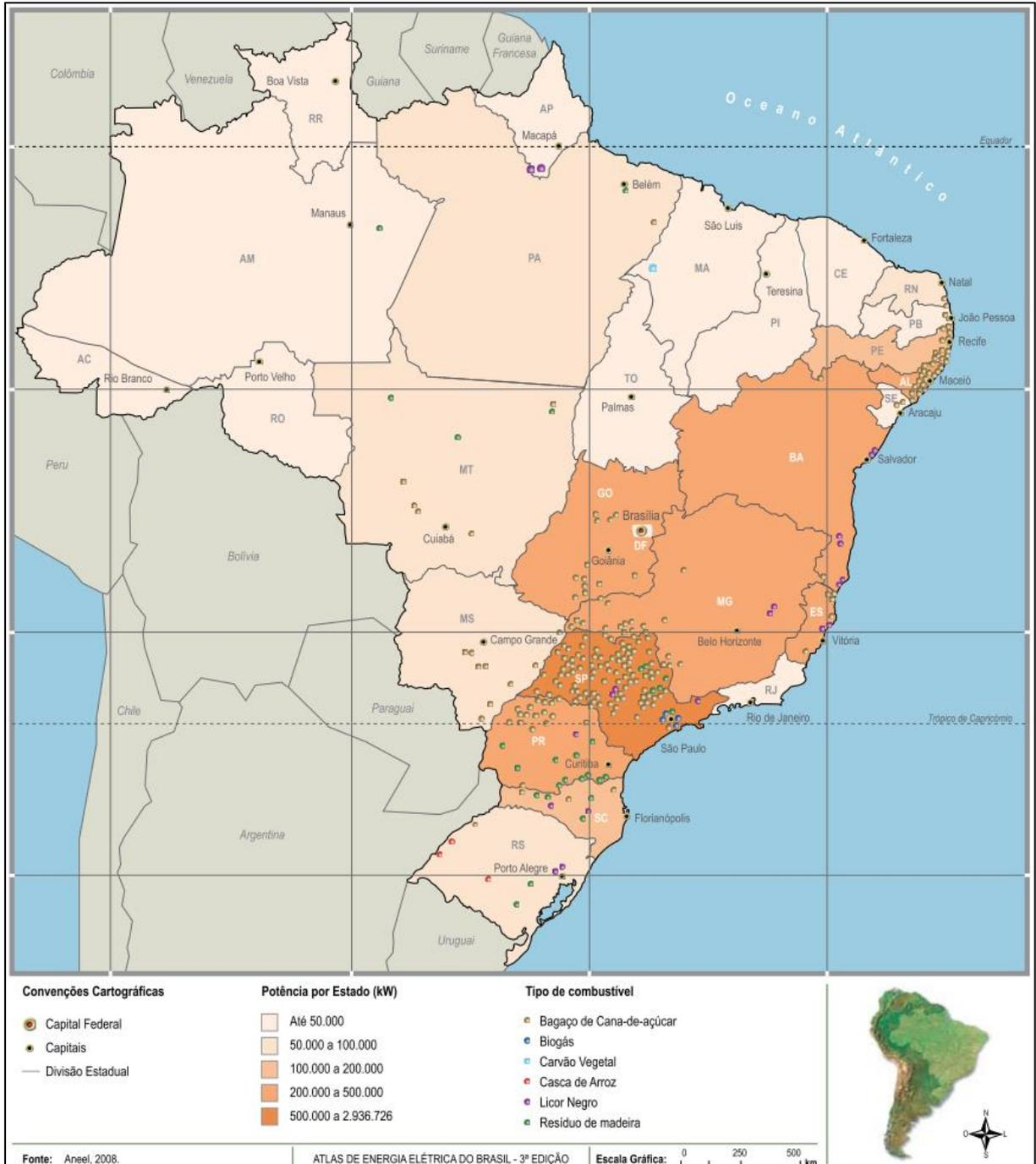
Figura 1 – Usinas de geração de energia elétrica, por estado brasileiro, que utilizam resíduos agrícolas ou agroindustriais como combustível. Adaptado de Aneel (2008).
