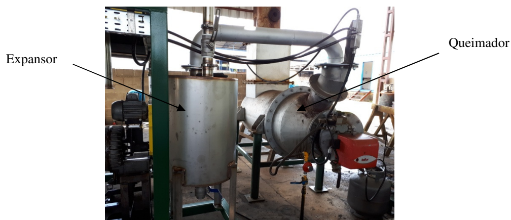
Figura A.15 – Gases restantes do processo: expansão, queima e recirculação
