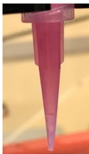
Figura 26 – Aspiração excessiva causada pelo alto tempo de suck back .
