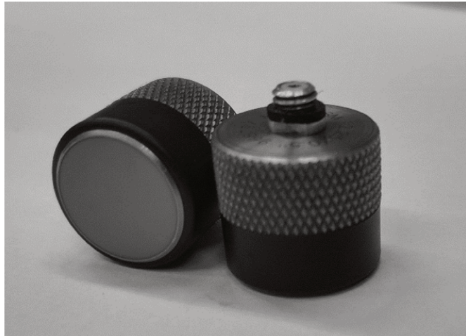
Figura 11 — Formato dos transdutores ultrassônicos usados nas medições via ultrassom dos escoamentos líquido-gás investigados
