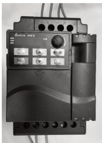
Figura 49 — Inversor de frequência (SY-101) utilizado no controle da rotação da bomba centrífuga
