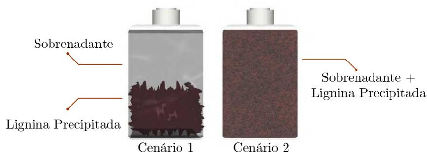
**Figura 5.5:** Processo de amostragem dos licores intermediários.
