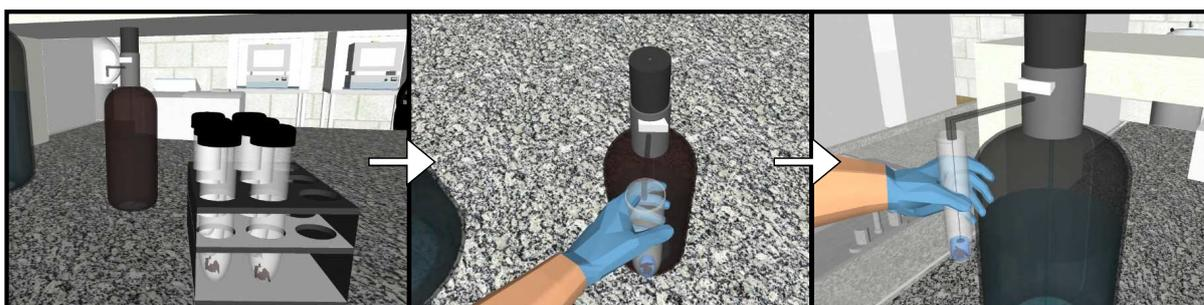
**Figura A.16:** Adição de ácido sulfúrico ( $H_2SO_4$ ) e água deionizada.
