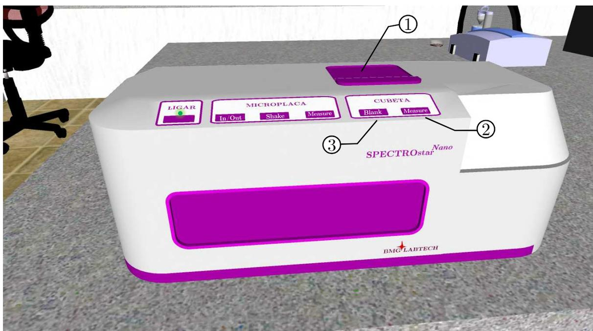
**Figura A.22:** Espectrofotômetro de varredura SPECTROstar Nano da BMG Labtech.
