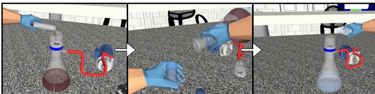
**Figura A.8:** Separação da lignina insolúvel e solúvel por filtração a vácuo.
