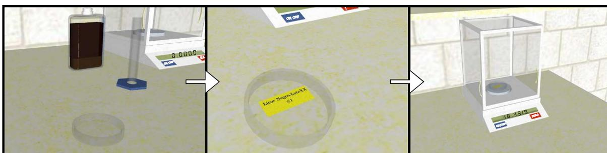
**Figura B.22:** Identificação e pesagem da placa de Petri vazia.
