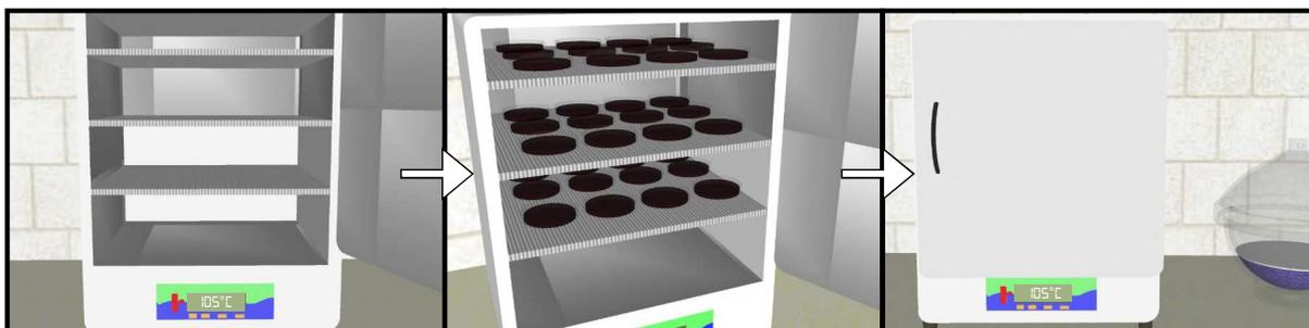
**Figura B.24:** Esquema de secagem das amostras na estufa à 105 °C.
