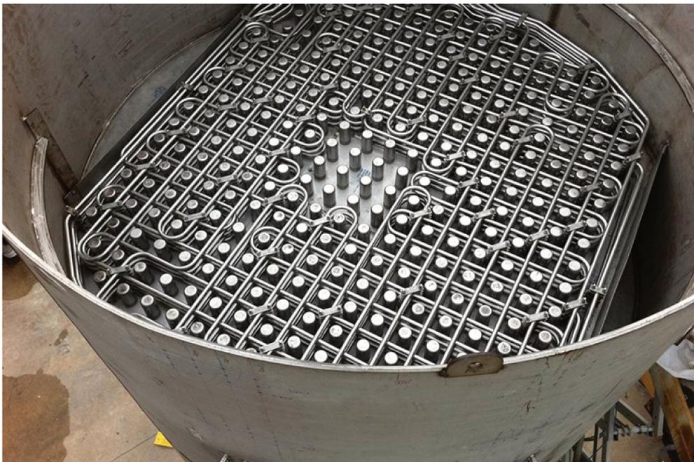
**Figura 2.8: Visão interna de prato de coluna com refrigeração individual por estágio. Fonte: Roberts Company.**
