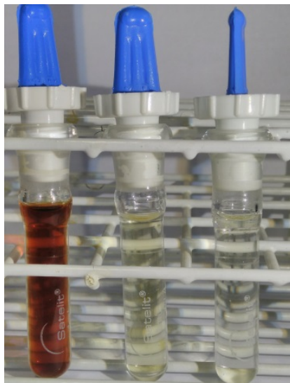
Figura 4.6 – Amostras da pré-purificação do caldo fermentado com glicose: Caldo concentrado (esquerda), fase leve (meio) e amostra pré-purificada (direita).
