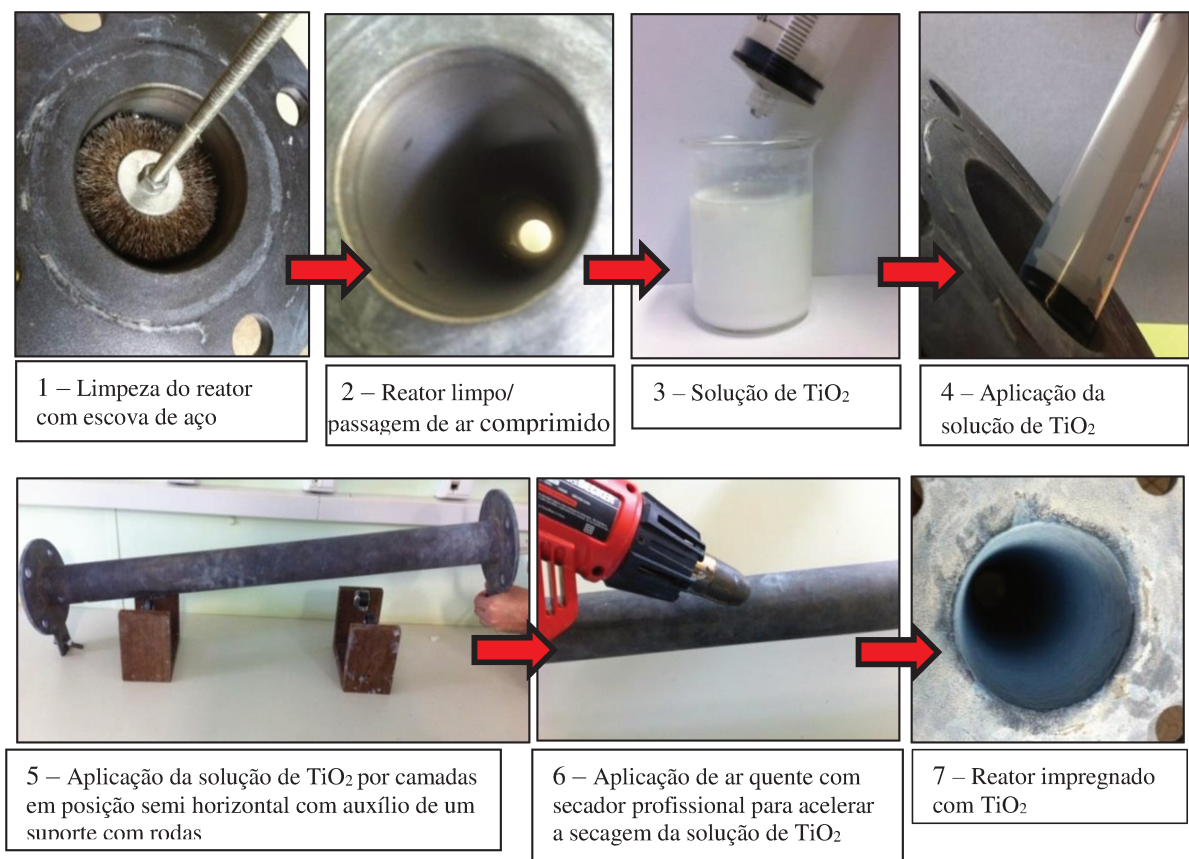
Figura 27: Etapas da impregnação do catalisador
