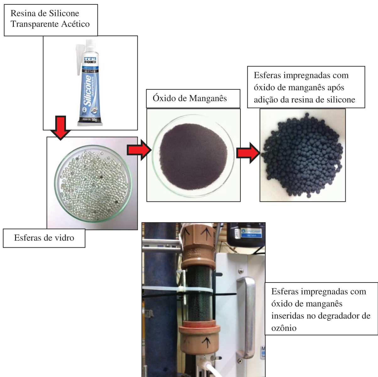
Figura 26: Etapas da impregnação das esferas de vidro com óxido de manganês e alocação do degradador ao sistema experimental
