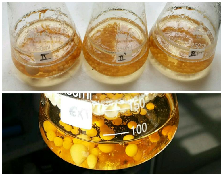
Figura 4- Meio de fermentação submersa composto por glicose e extrato de levedura após incubação por 7 dias à 28°C, com agitação em agitador orbital de 150 rpm.
