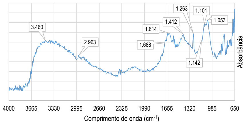
Figura 20. Espectro obtido por FTIR do DMPE-AH purificado.
