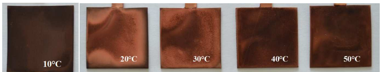
Figura 24 – Depósitos de cobre em diferentes temperaturas e 115 min de reação
