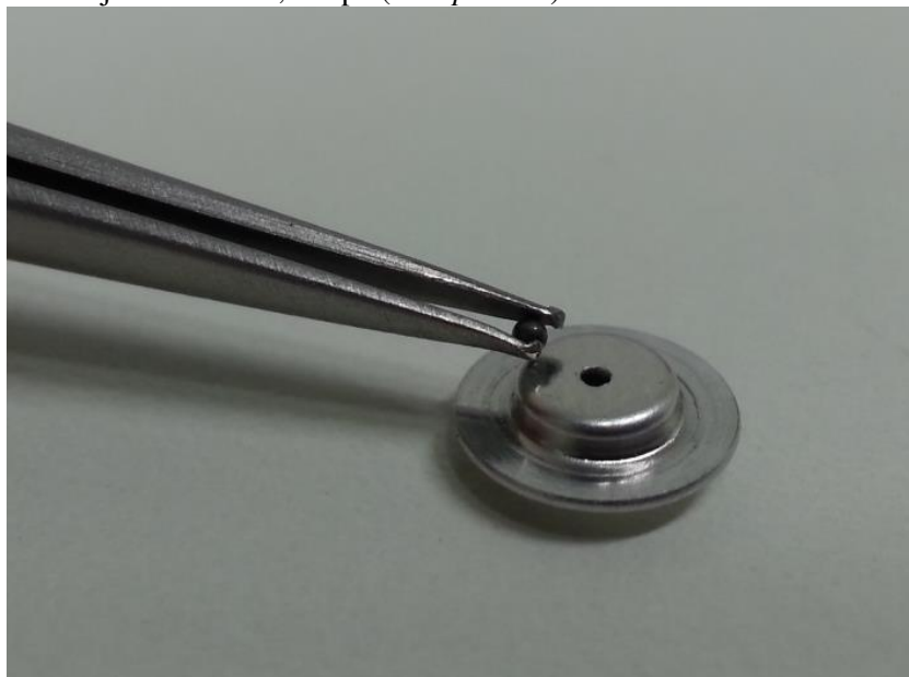
Figura 2.5. Conjunto cadinho, tampa (com pinhole ) e esfera de carboneto de tungstênio.
