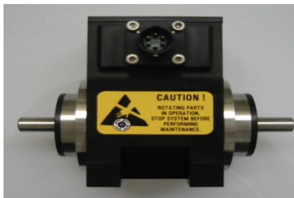
Figura 4.13 – Torquímetro TM 307 fornecido pela Magtrol. Fonte: Jefferson Luiz Grangeiro da Silva (arquivo pessoal).
