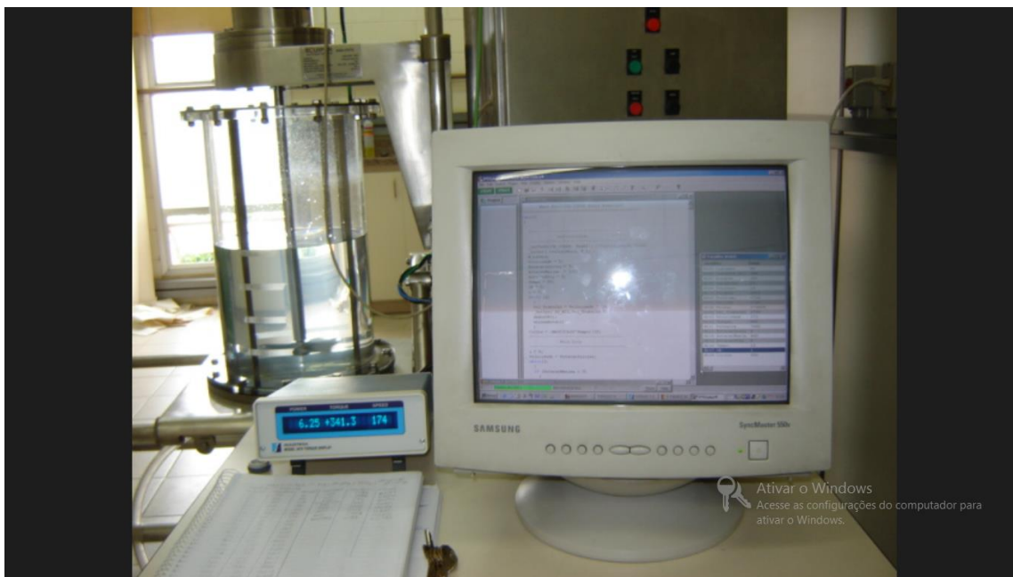
Figura B1 – Dados de Entrada do software MAGTROL (TORQUE 1.5) com informações da rotação inicial, rotação máxima (para cada tipo de impelidor estudado) e o passo de tempo (15 em 15 segundos para cada mudança de rotação de 5 em 5 rpm). Fonte: Jefferson Luiz Grangeiro da Silva (arquivo pessoal).
