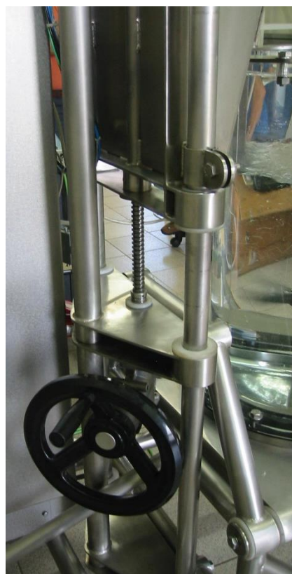
Figura 4.7 – Sistema de elevação do agitador da unidade piloto de 50 L. Fonte: Souza (2011).
