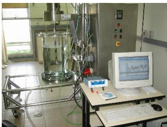
Figura 4.3 – Fotografia da unidade piloto de 50 L e o sistema de aquisição de dados para leitura da velocidade rotacional e medidas de torque. Fonte: Jefferson Luiz Grangeiro da Silva (arquivo pessoal).
