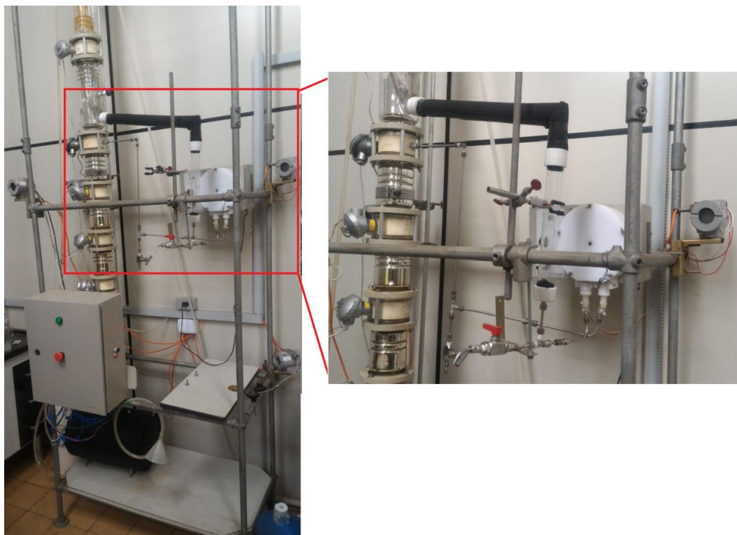
Figura 4 - Coluna de destilação (a) e detalhe do refluxo externo (b)
