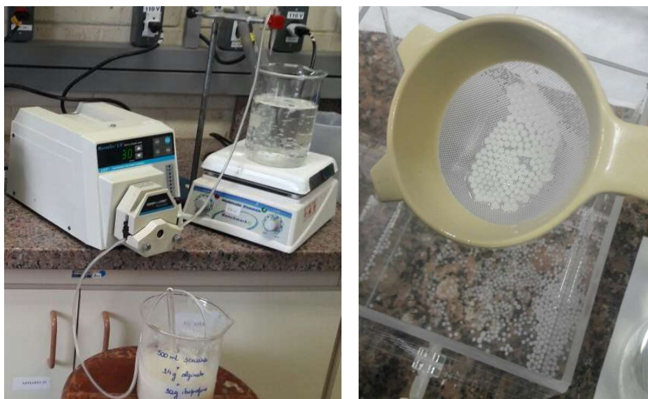
Figura 3-4. Sistema de gotejamento seguido de reticulação para formação das partículas.
