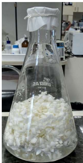
Figura 3-3. Erlenmeyer preparado para a extração da sericina em autoclave.
