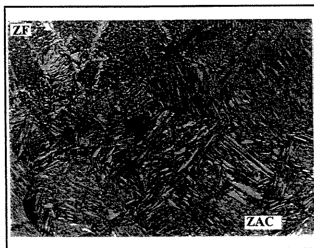
Figura 4.5: Micrografia representativa da interface sólido-líquido. Início da solidificação epitaxial (1000x) Nital 2%
