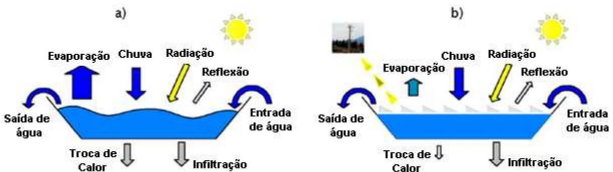
Figura 2.8: Balanço água-energia.
