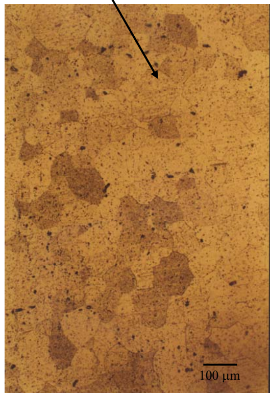
Figura 4.65 - Peça típica obtida por tixoestampagem a 630°C, de chapa da liga A5052 com 4,0 mm de espessura, e microestrutura das regiões indicadas.
