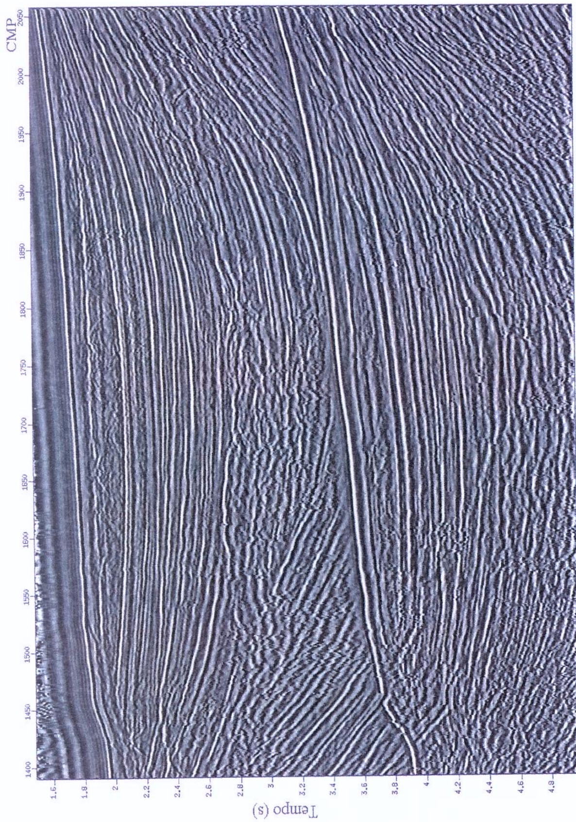
Figura 4.42: Seção empilhada CRS otimizada para os dados maríimos com múltiplas.
