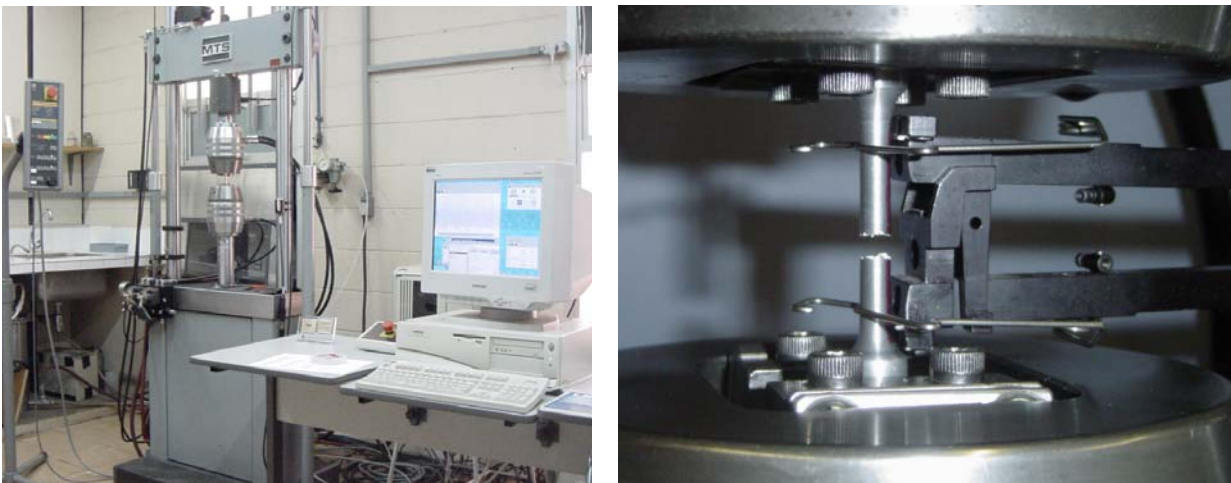
Figura 3.13. Máquina universal de ensaios (MTS - Mechanical Test System 810) utilizado no ensaio de tração.
