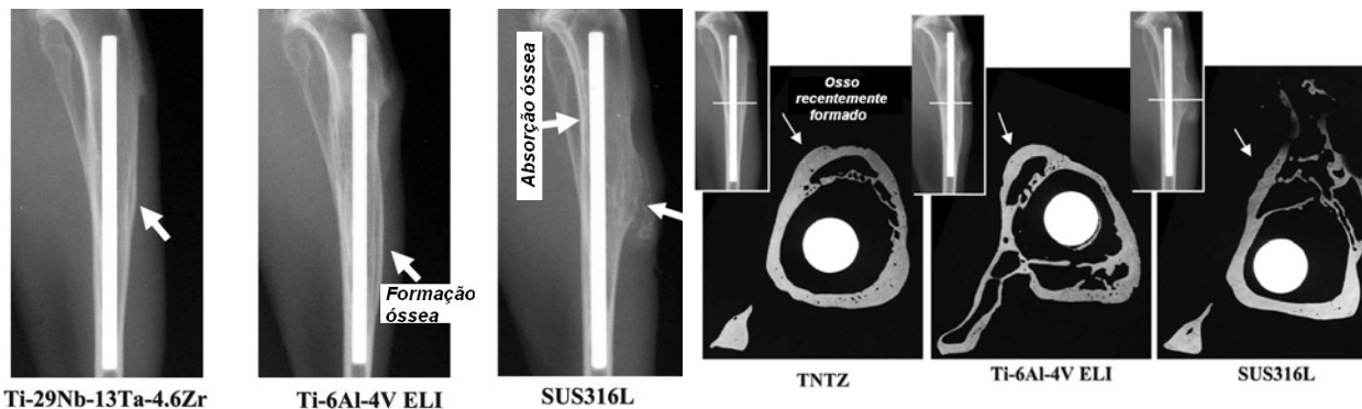
Figura 2.10. Processo de osteossíntese da fratura óssea da 0 a 22ª semana após a cirurgia para (a) Ti-29Nb-13Ta-4,6Zr, (b) Ti-6Al-4V ELI e (c) aço inoxidável SUS 316L [Niinomi, 2008].
