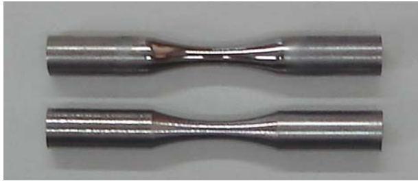
Figura 3.17. (a) Corpo de prova de fadiga, usinado e após polimento (b) Dimensões nominais do corpo de prova em milímetros.
