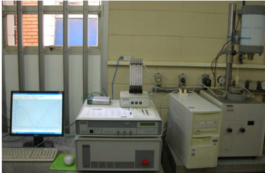
Figura 3.10. Equipamento STA409C - Netzsch utilizado na análise de calorimetria exploratória diferencial.
