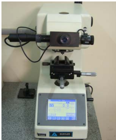
Figura 3.12. Equipamento utilizado para as medidas de microdureza Vickers e diagrama esquemático da impressão.
