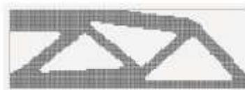
Figura 2.6: Exemplo de otimização utilizando método ESO (Huang e Xie, 2010)
