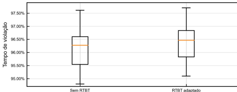
Figura 5.18 – Porcentagem de tempo de violação dos limites de fator de potência para simulações Monte Carlo sem e com RTBT adaptado na rede BT com maior custo de transgressão de subtensão.
