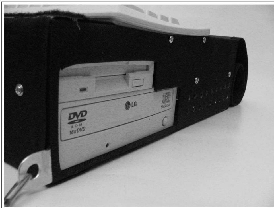
Fig. 4.17: Computador Pessoal Compacto - Protótipo Drives
