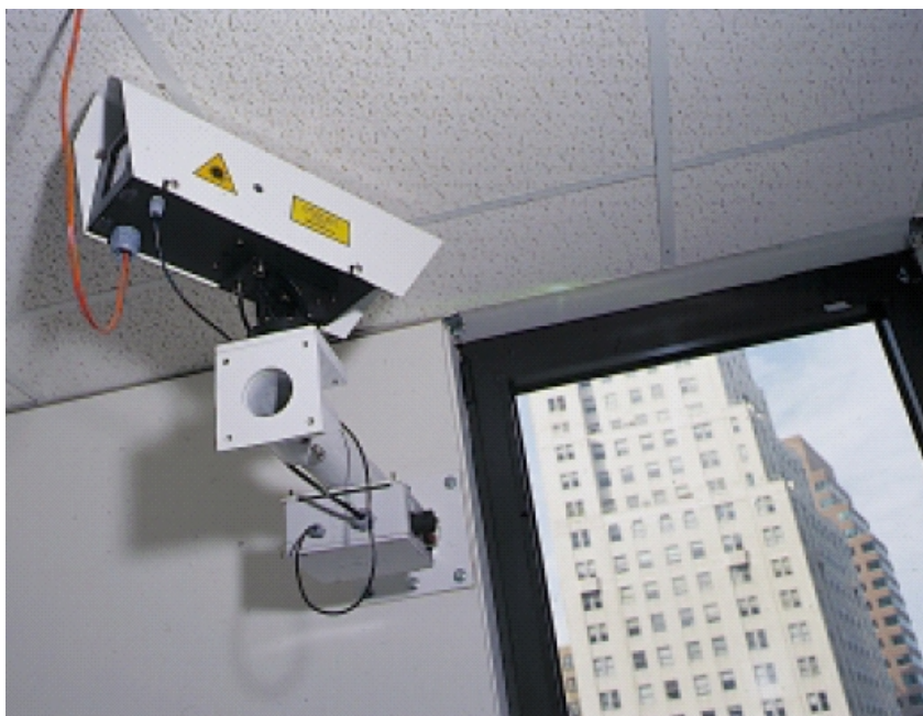
Figura 3 - Dispositivo FSO ligando dois escritórios de direito, Cadwalader, Wickersham & Taft , separados em 100m em edifícios comerciais em Manhatan , link de 1.25Gb/s [21]
