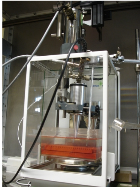
Fig. 5.29 – Balança de radiação acústica com transdutor T1: medição da potência ultrassônica para cálculo da condutância de radiação do T1.
