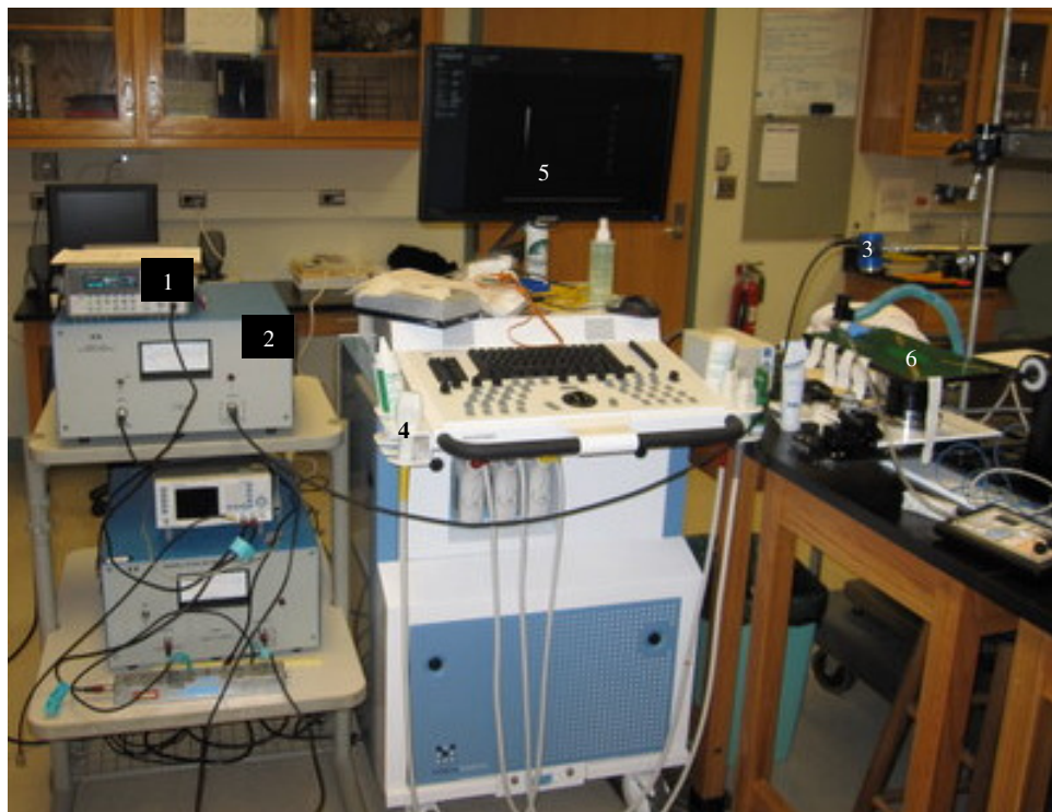
Fig. 7.2 – Montagem experimental contendo gerador de sinais (1), amplificador de RF (2), transdutor de ultrassom de terapia (3), transdutor de ultrassom de imagem (4), sistema de ultrassom VisualSonics (5), e plataforma cirúrgica (6), onde era colocado o rato.
