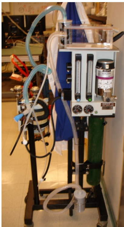
Fig. 7.3 – Sistema de anestesia contendo isoflurano, cilindro de oxigênio, dois filtros, sendo um ligado à câmara de acrílico e outro conectado à máscara facial.
