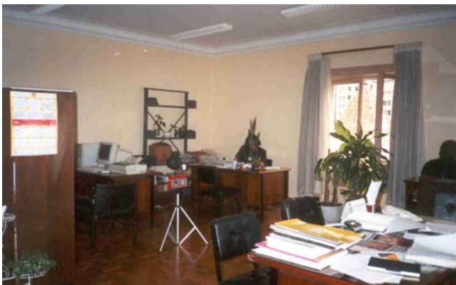
Foto 3: Nesta foto se vê o termômetro de globo, localizado no meio da sala.
