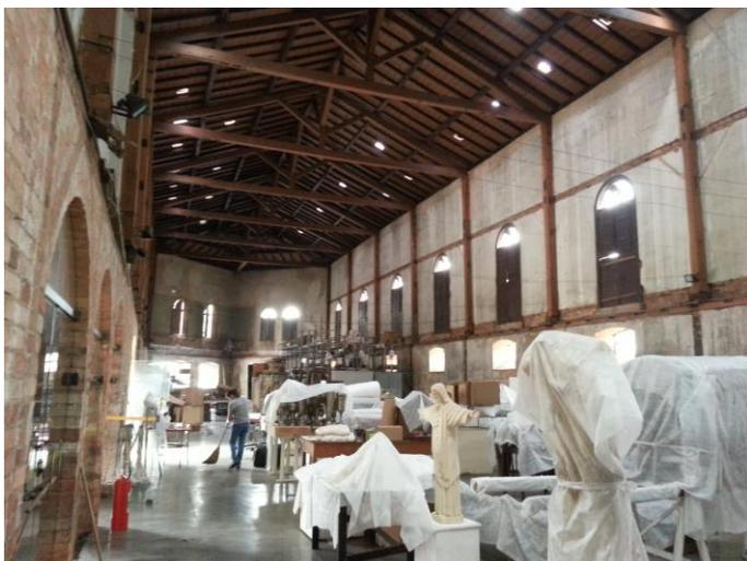
FIGURA 101 Interior do galpão principal, cujas marcas das mudanças empreendidas ao longo dos anos foram mantidas no restauro feito em 1991. Quando iniciaram-se os primeiros levantamentos para o restauro, este galpão já não apresentava mais nenhuma parede divisória e nenhuma estrutura de piso e de forro, que foram removidas em meados do século XX, provavelmente, quando o edifício foi readequado para o funcionamento de uma garagem de vagões de trem. Foto da autora, 2015.
