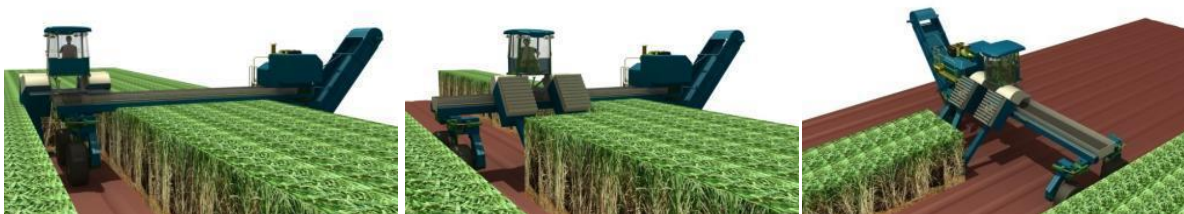
Figura 7: ETC – módulo colheita de 2 linhas
