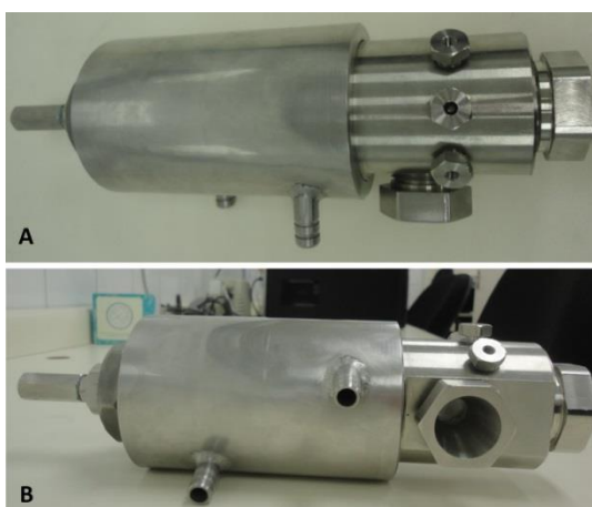
Figura A14. Célula de equilíbrio e camisa de aquecimento. A) Vista superior: entradas para conexão e termopar; B) Vista lateral: janela de safira lateral.
