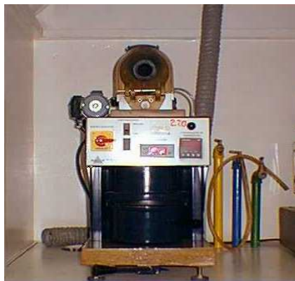
Figura II.1: Torrador PROBAT-WERKE tipo PRE 1.
