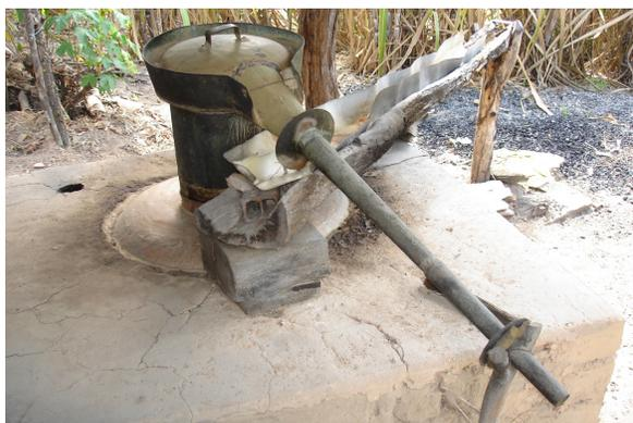
Figura 29. Alambique de carapuça com calha para escorrer a água quente.
