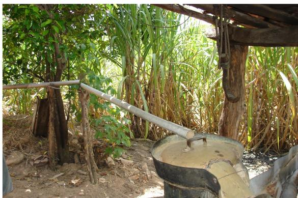
Figura 28. Alambique de carapuça, com calha de refrigeração.
