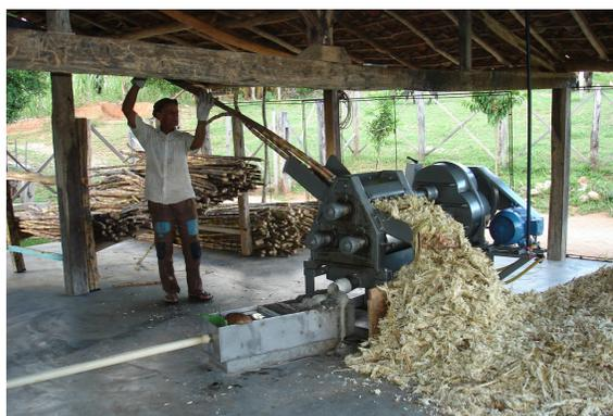
Figura 23. Moenda em funcionamento, com canas dispostas em local seco e suspenso.
