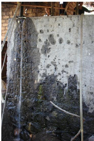
Figura 44. Saída da água quente do condensador, à esquerda, e entrada da água fria por um cano, à direita.
