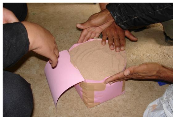
Figura 61. Deformação do cubo de 16 cm de aresta observada pelos professores. Bocaina, Piatã - BA.
