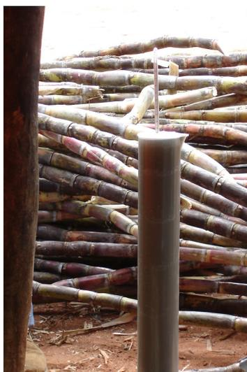
Figura 79. Sacarímetro indicando o teor de açúcares do caldo.
