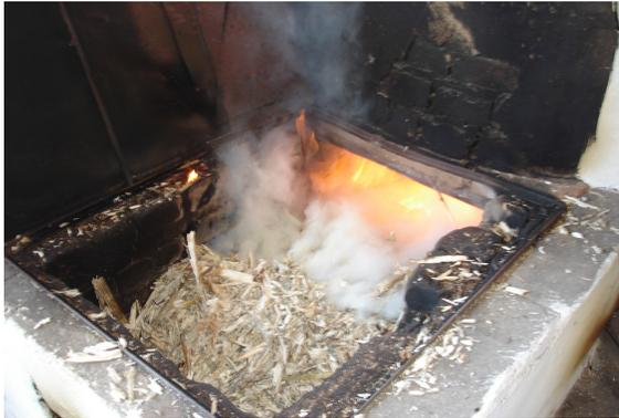
Figura 36. Fornalha própria para bagaço.
