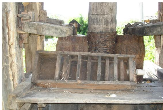
Figura 43. Decantador de madeira desativado.
