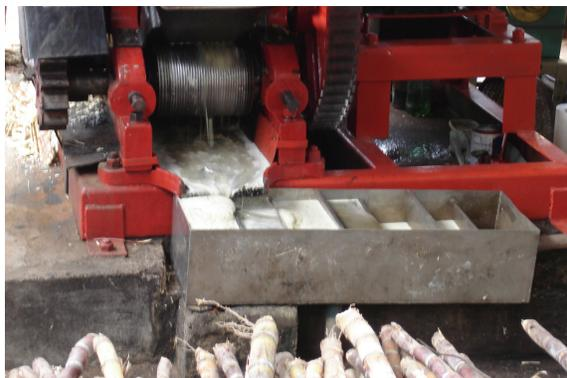
Figura 41. Decantador em funcionamento no engenho de Luís.
