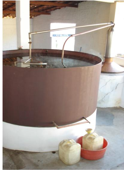
Figura 37. Condensador com duas serpentinas.
