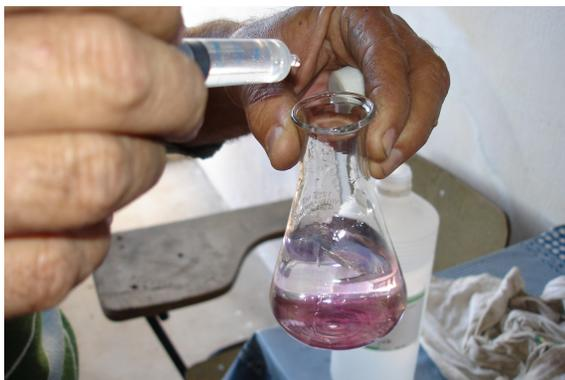
Figura 53. Adição de hidróxido de sódio em cachaça com com fenolftaleína no teste da acidez realizado por Rui.
