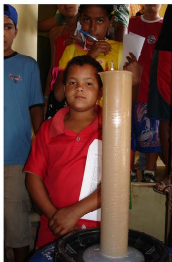
Figura 80. Sacarímetro indicando 0° Bx no caldo já fermentado.
