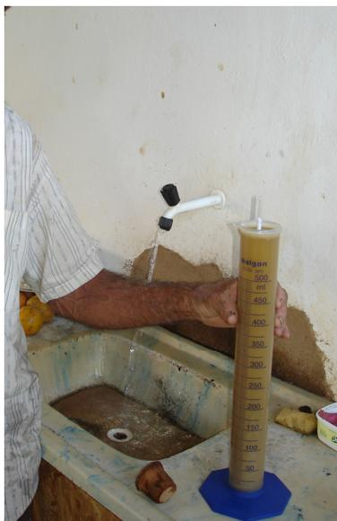
Figura 55. Sr. Edvaldo fazendo uso do sacarímetro para determinar o término da fermentação.
