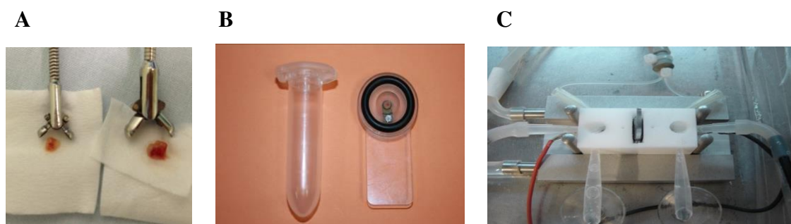
Figura 11: Fragmentos de biópsias retais e câmara de Ussing A. Fragmentos de biópsias retais B) Insert com a biópsia. C) micro-câmaras de Ussing . Arquivo Lafic-Ciped (Unicamp).
